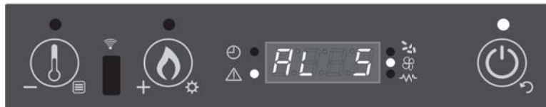
Visualización del mensaje que se desplaza en la pantalla: AL 5 ALAR AL 5 FALLO ENCENDIDO
