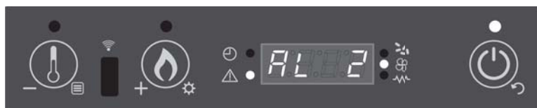
Visualización del mensaje que se desplaza en la pantalla: AL 2 ALAR AL 2 Sonda HUMOS
