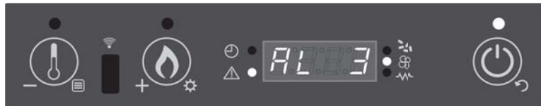
Visualización del mensaje que se desplaza en la pantalla: AL 3 ALAR AL 3 HUMOS HOT
